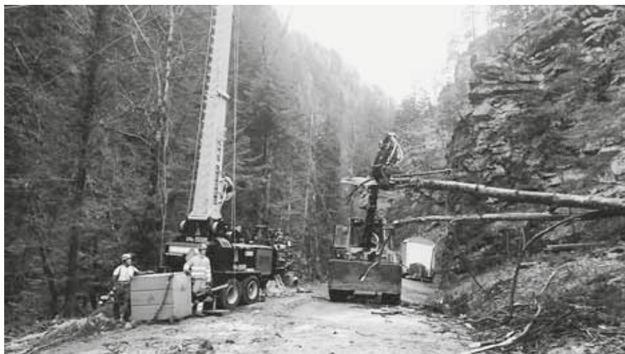
Mobilseilkran KMS 4000U im Einsatz, Sicherheitsholzschlag Badtobel (Staatswald Pfäfers)
